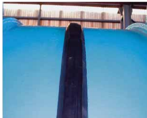
内水圧0.5MPa、継手30mmのゴム膨らみ
