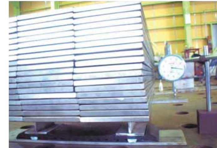
内面バンドゴムの载荷重と圧縮量測定
