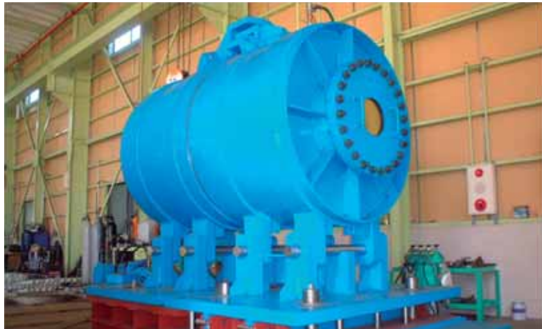
水圧試験機全景
