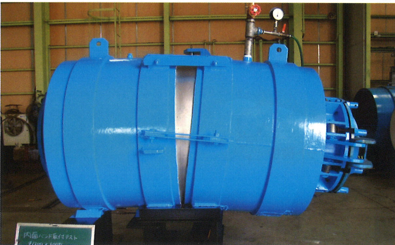
内水圧1.0MPa、曲げ角8度
